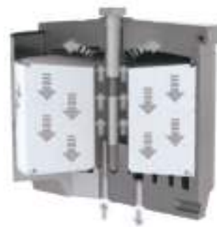
Diagrama de funcionamiento del elemento filtrante CARDEV SDFC.
