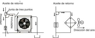
Válvula de alivio para aceite a alta presión. Usando resorte con precarga o 6 Bar.
