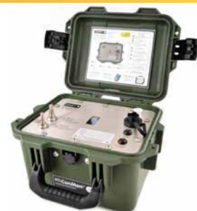
Analizador tecnología láser para aceites y combustibles Recuento de partículas y porcentaje de humedad
